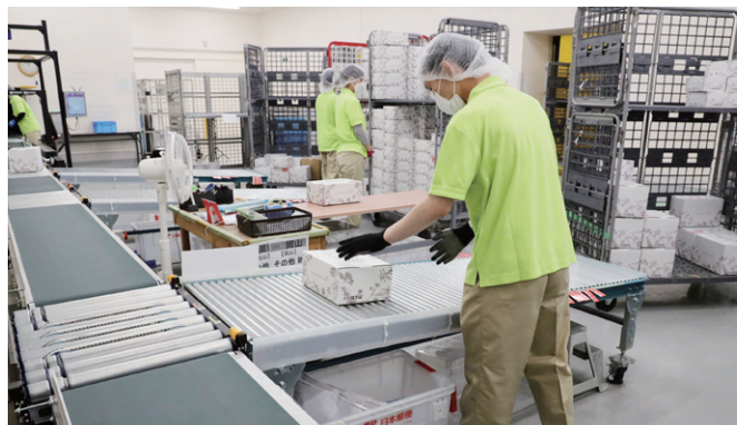
荷物のサイズ・重さを自動で計測し、測定結果を元に仕分ける
