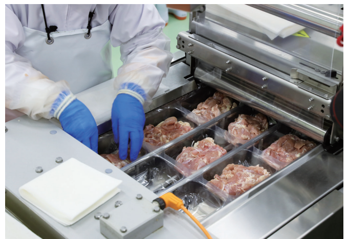
戸田チルドセンターで稼働中のTERAOKAノントレー包装機「TFS-100」
