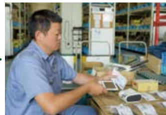
ノギスで採寸して検品した後、モバイルハンディーで情報を確認。ラベルを発行して添付した後、各棚ごとに決められた台車に乗せる
